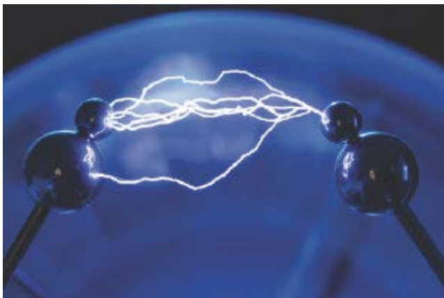
Εικόνα 1 Ηλεκτρικό τόξο ανάμεσα σε δύο φορτία
