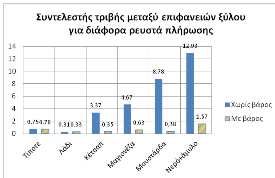
Διάγραμμα 2: Οι τιμές τριβής μεταξύ των δύο ξύλων με την προσθήκη βάρους 1,48N επάνω στο ξύλο και το αντίστοιχο υλικό ανάμεσά τους.
